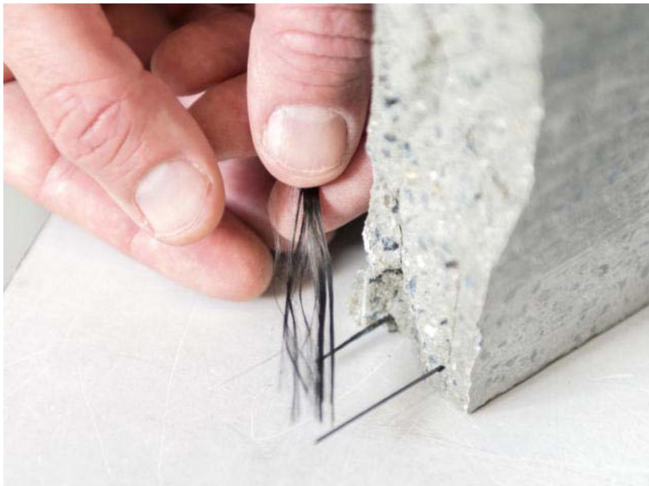
Die Armierung mit vorgespanntem Carbon macht die dünnen Betonplatten besonders stabil. (Bild: ZHAW)
